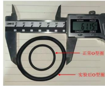
a) 内径 28 mm、线径 2.65 mm O 形圈失效
